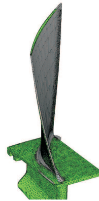
Abbildung 9. Morphoberfläche mit FE-Netz
